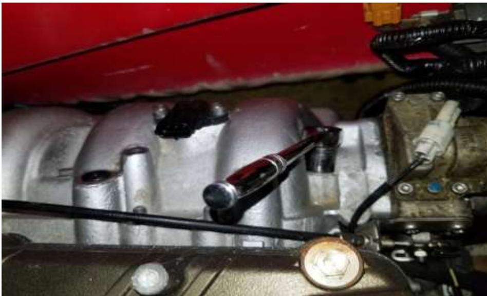
22. Remove the bottom bolt.
